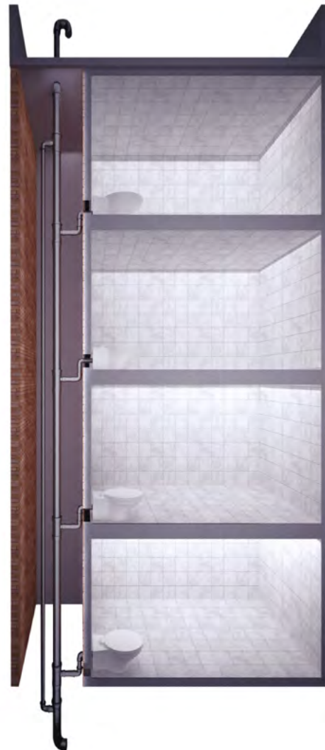
شکل ۸ سیستم فاضلاب بدون هواکش مستقل
