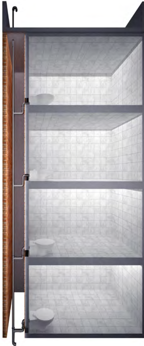
شکل ۷ سیستم فاضلاب با هواکش با قطر کمتر
