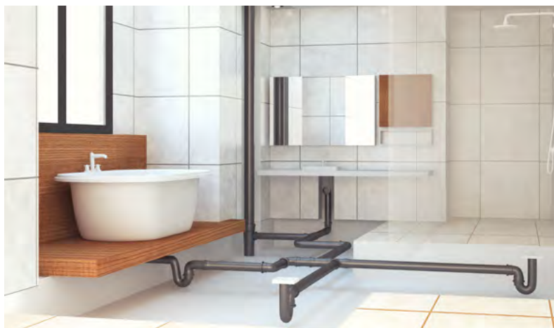
شکل ۲ نمای اجرای پلی تک در حمام
